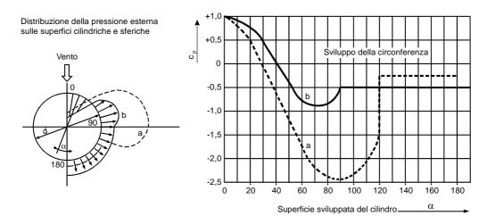
**Figura 3.3.12 -** Coefficienti di pressione esterna delle superfici cilindriche e sferiche: curva (a) per superfici lisce (metalil, intonaco liscio); curva (b) per superfici ruvide (muratura con giunti di malta, intonaco rustico)
