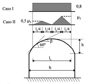
Figura 3.5.7 – Disposizioni di carico per coperture cilindriche
