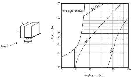
Figura 3.3.13.a - Valori del coefficiente dinamico degli edifici in c.a. o in muratura
