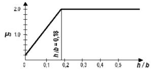
Figura 3.5.8 – Coefficienti di forma per coperture cilindriche
