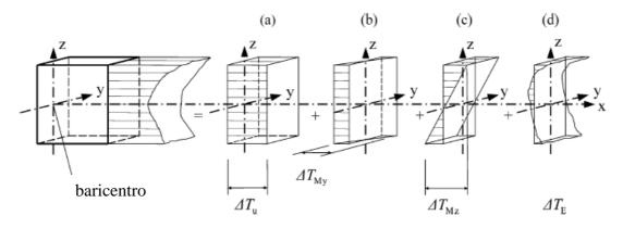
Figura 3.4.1 - Componenti della distribuzione di temperatura per un elemento monodimensionale
